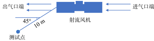
图 3 风机标准噪声测试方法示意 [14]
